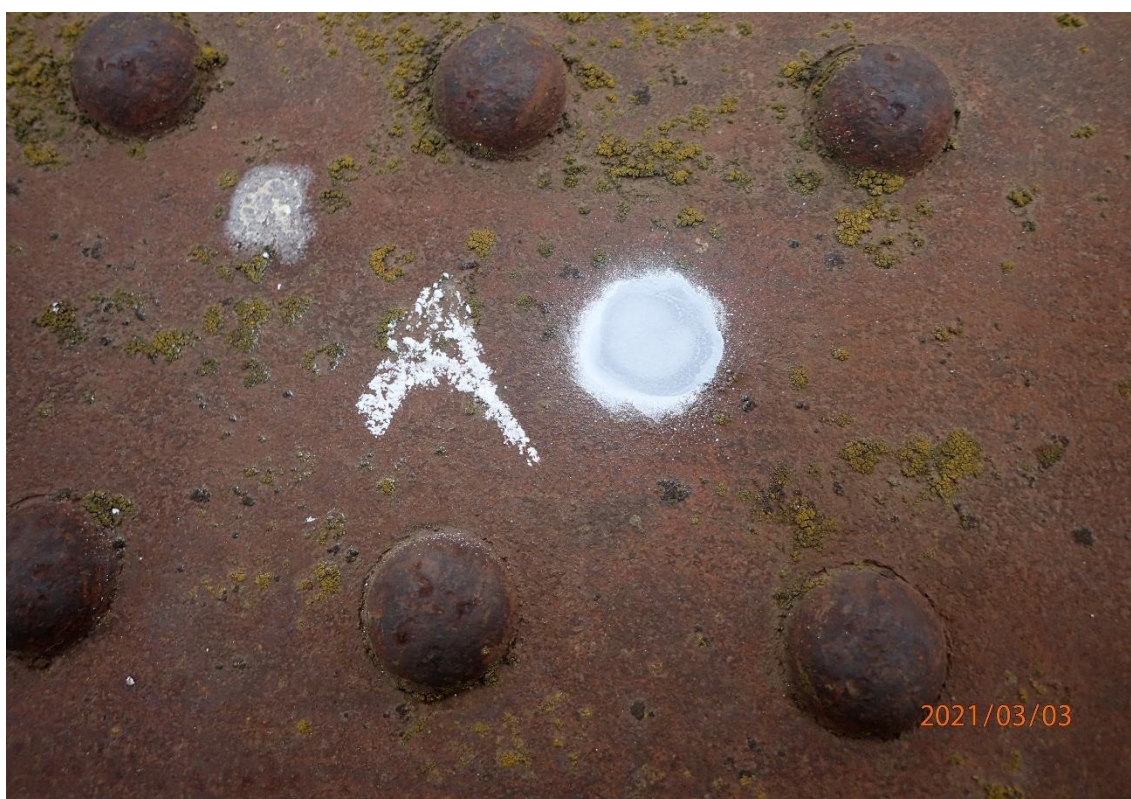
Obr. 54: Zkoušené místo po ukončení zkoušky a aplikaci ochranného nástrihu
