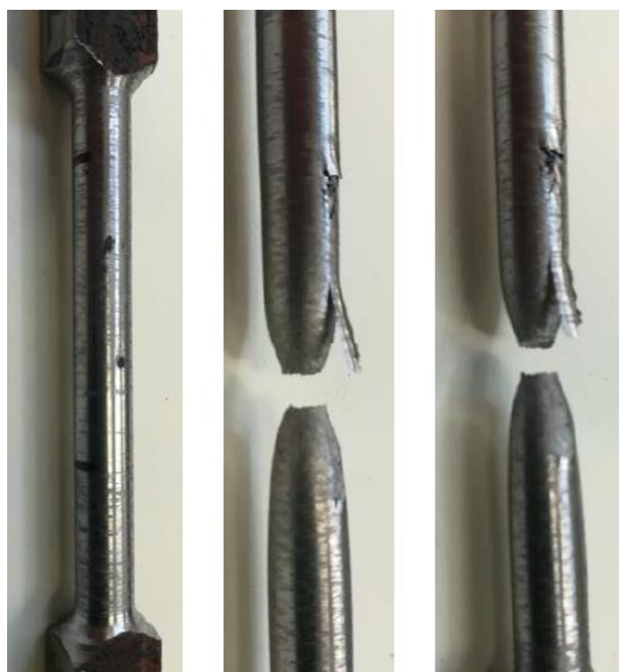
Obr. 67: Vada vzorku 53-P-LN/2 po zkoušce (odlomení hrany)
