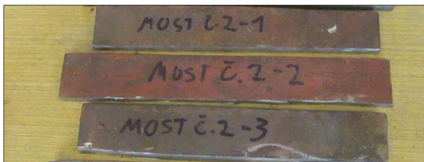
Obr. 6 Ocelové vzorky odebrané z mostu ev. km 53,696.
