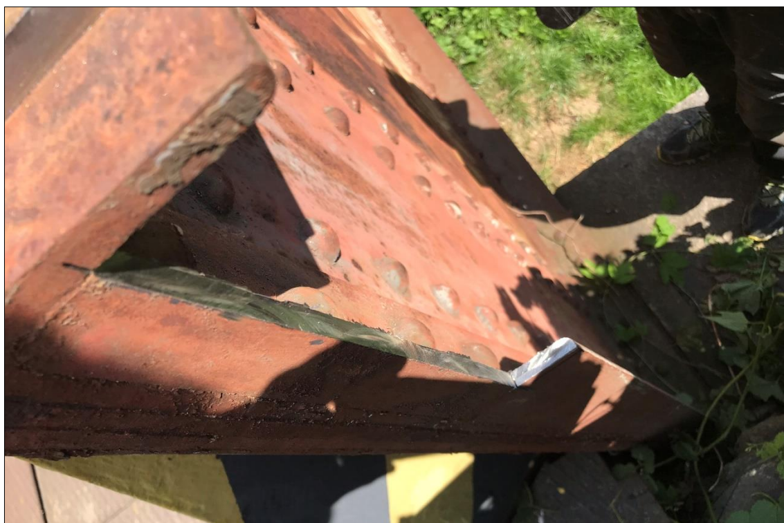
Obr. 5 Vzorek číslo 2-2 – L výztuha nad opěrou
