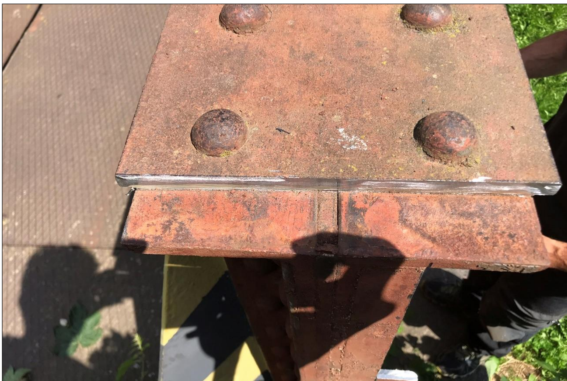
Obr. 4 Vzorek číslo 2-1 – horní plát horní pásnice
