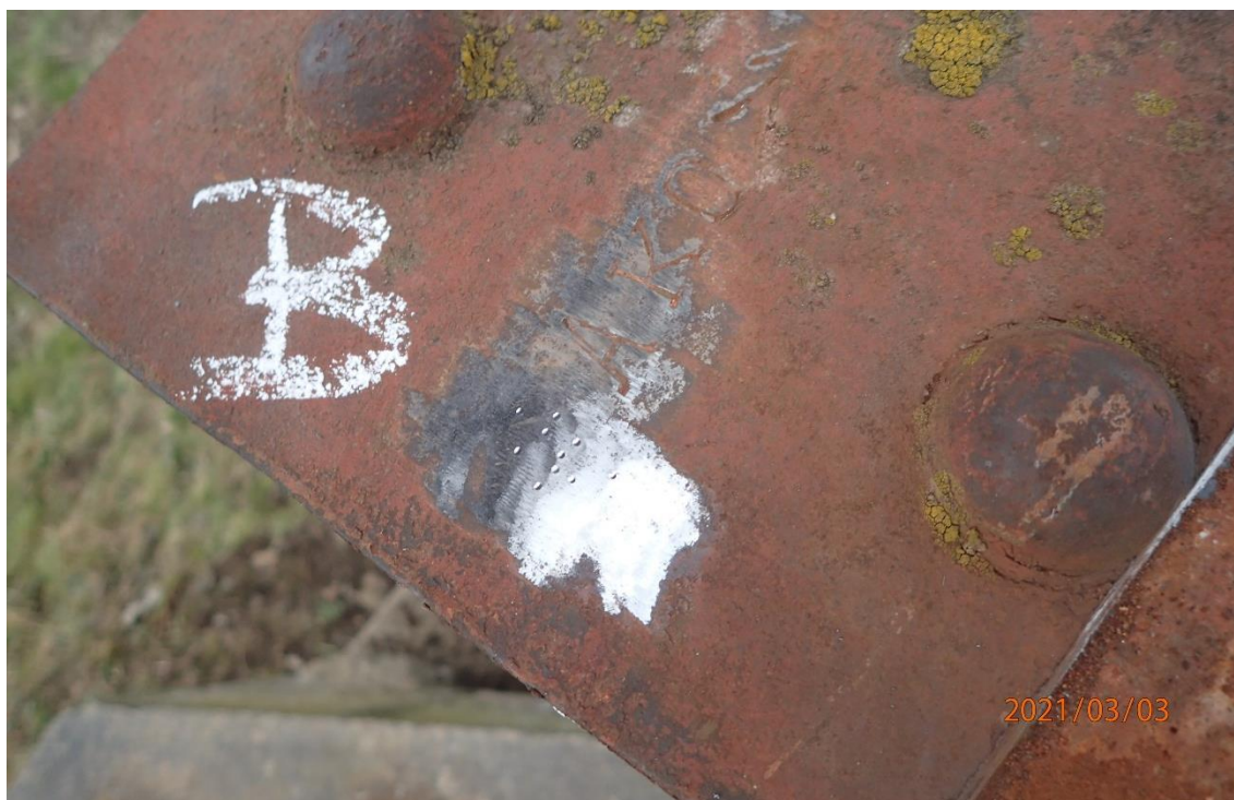
Obr. 53: Očištěné místo pro tvrdoměrnou zkoušku
