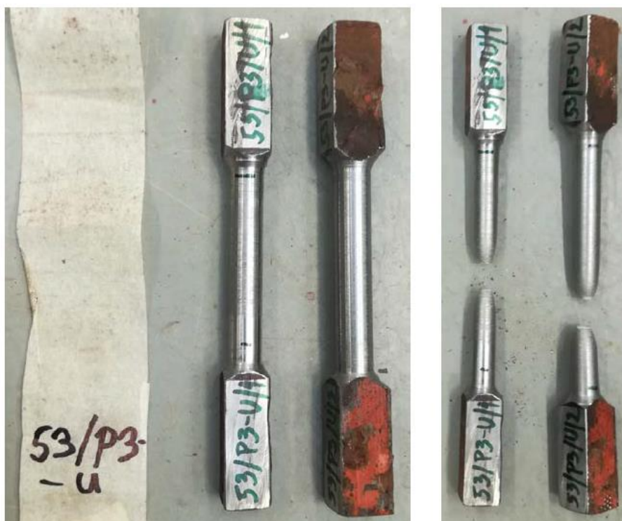
Obr. 66: Vzorky před zkouškou a po zkoušce
